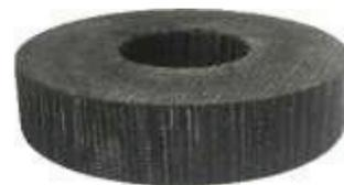
Композиционный углерод-углеродный материал на основе трехмерного каркаса с соотношением нитей по осям X:Y:Z соответственно 2:2:1, насыщенного пироуглеродом из газовой фазы.
